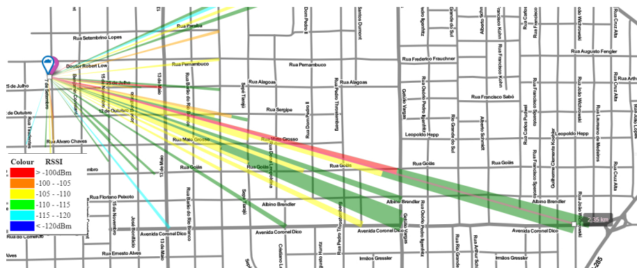
Figura 4. Cobertura de Sinal do Protótipo no TTN Mapper [26]
